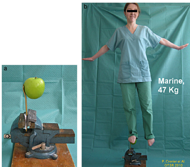
Figure 23 a : montage avec pomme fixée par cinq vis verrouillées sur une plaque pour fémur distal ; b : test de mise en charge.
